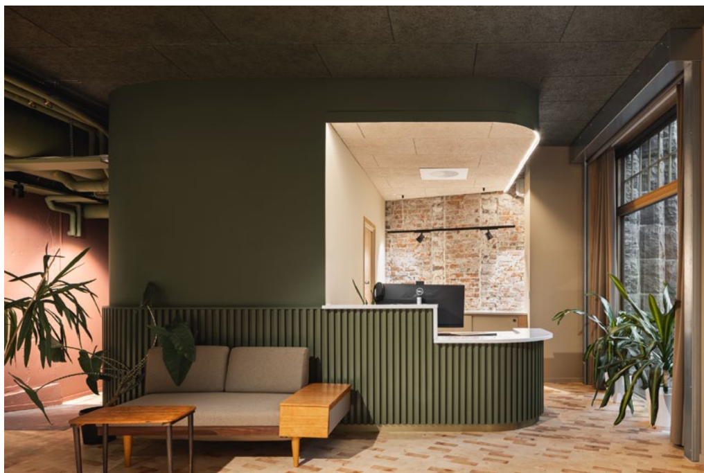
Resepsjonsen er spesialdesignet til bygget. Brystningspillene som går igjen flere steder på grunnplanet har fått et strøk maling etter å ha blitt ombrukt fra himlingen i et gammelt kontorbygg.
