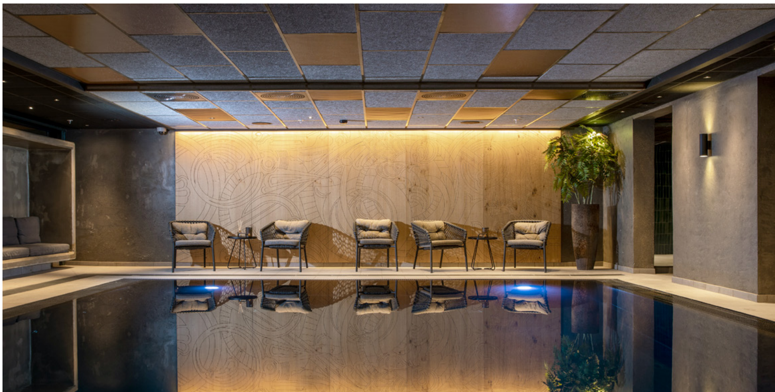
Fondmotivet bak svømmebassenget henter inspirasjon fra dragestilornamentikk, og er frest inn i trefinerte sorte valcromatplater.
