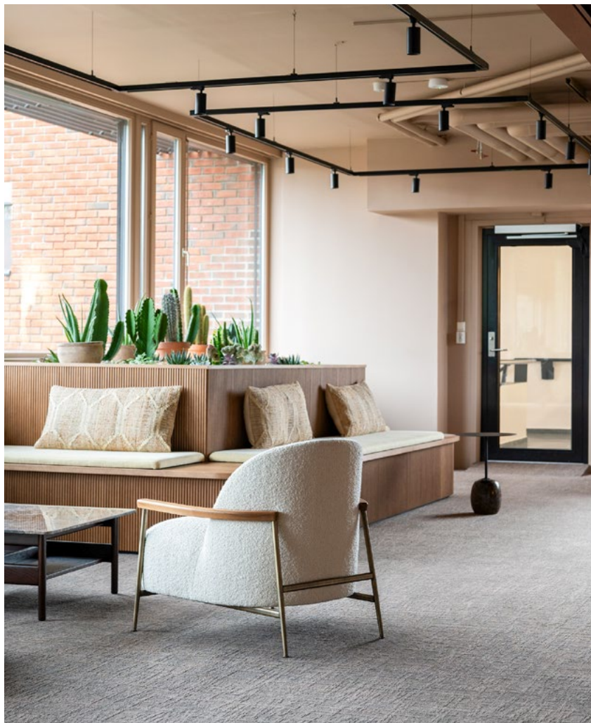
Inngangssonen er møblert med en uformell lounge og spesialdesignet sittebenk i eik som også skjuler toppen av en heissjakt som stikker opp av dekket. Eikepaneler med halvstaffspiler går igjen i fastinnredningen og veggkledning og er et bindende element i interiøret. Som her vist i sittebenken i lokalets inngangsparti.
