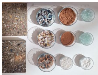
«Sirkulær» av Kristine Matland. Bygningsmaterialer som knuses og støpes om til nye materialer. Brukes på gulv og benkeplater i ny løsning.
