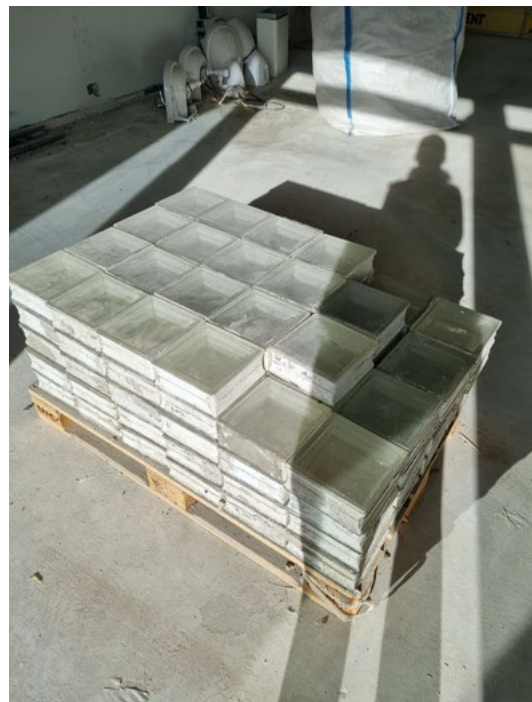
Det var glassbyggerstein mellom etasjene og trapperommet på alle plan. Den kunne ikke stå der lenger pga. for dårlig brannkrav, men de kvittet seg ikke med den og designet heller møbler og innredning med dette fullt brukbare materialet fra bygget.
