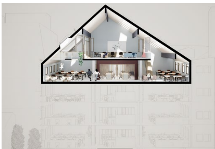
Gjenninsetting av glass mellom 5. og 6. etasje samt nye takvinduer gjør begge disse etasjene brukbare og attraktive.
