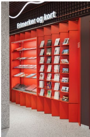
Vegghylle med produkter som ikke skal være tilgjengelige på kveldstid, pivoterer når butikken går fra betjent til selvbetjent.
