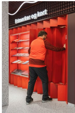
Vegghylle med produkter som ikke skal være tilgjengelige på kveldstid, pivoterer når butikken går fra betjent til selvbetjent.
