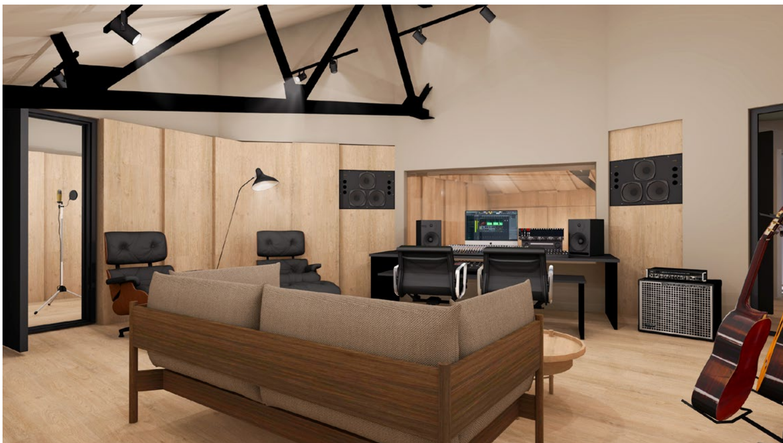
Ulike overflater i rommet er strategisk skråstilt for å styre lydens bevegelser og redusere uønskede refleksjoner.
