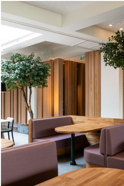
Fellesareal: Sofabåsene er tilpasset det eksisterende interiøret, men utført i en høy andel ombruksmaterialer. Her er deler av lyktestolper brukt som understell, Rewo heltreplater og overskuddstekstil fra Kupp.
