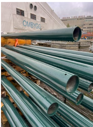
Prosess: Brukte lyktestolper fra Ombygg erstattet nytt stål i bordunderstell.
