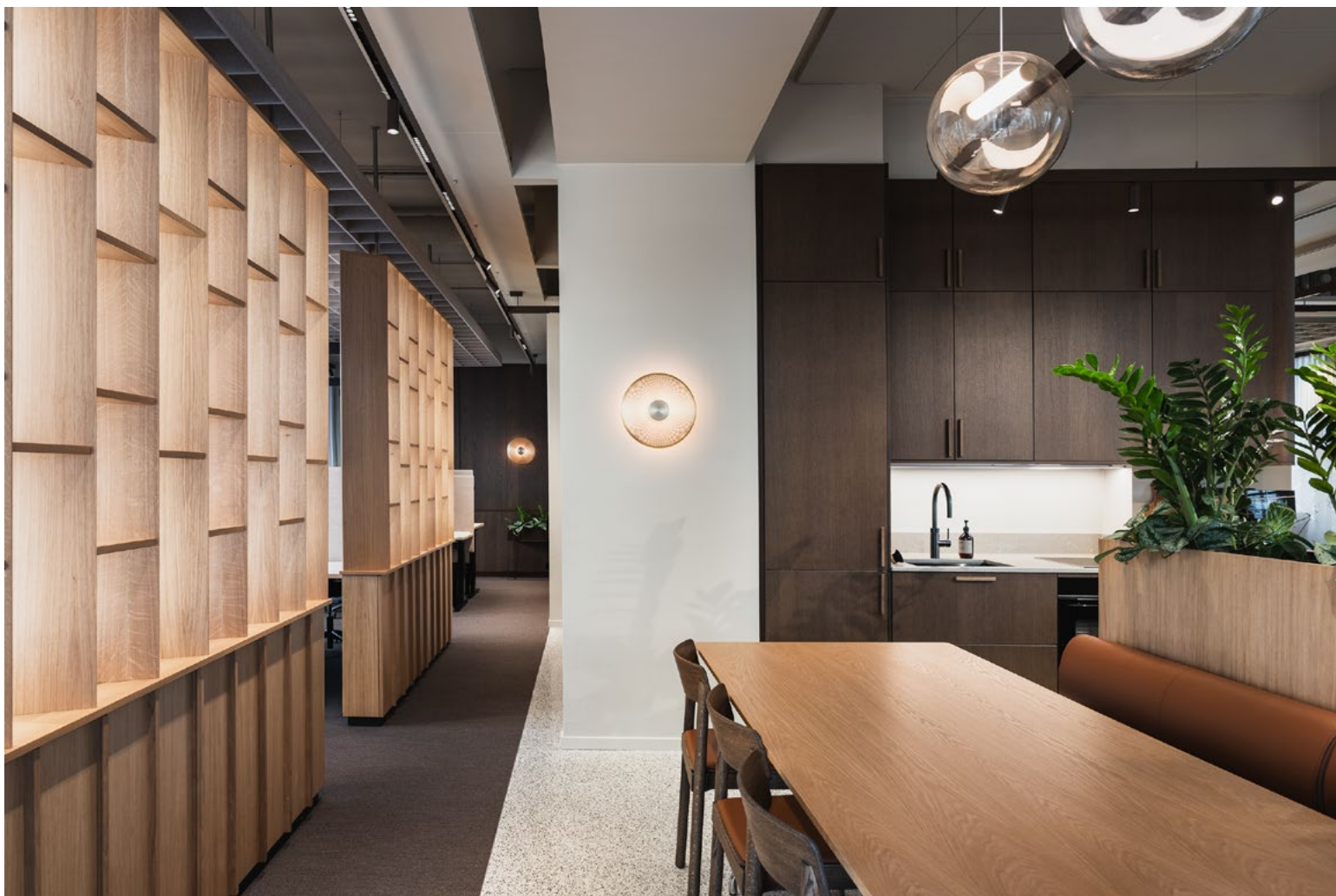
Monn har jobbet tett med Stokkan Lys for å oppnå et fleksibelt og komfortabelt lysuttrykk. Alt er på Dalistyring koblet til KNX system.
