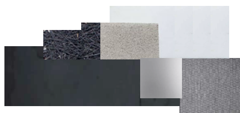
GRUNNPALETT BYGG - åpne arealer: Betong, sort varmvalset stål, brunt skinn, grått beløpentepp, aluminium, glassgranulat og sort treullsement.
