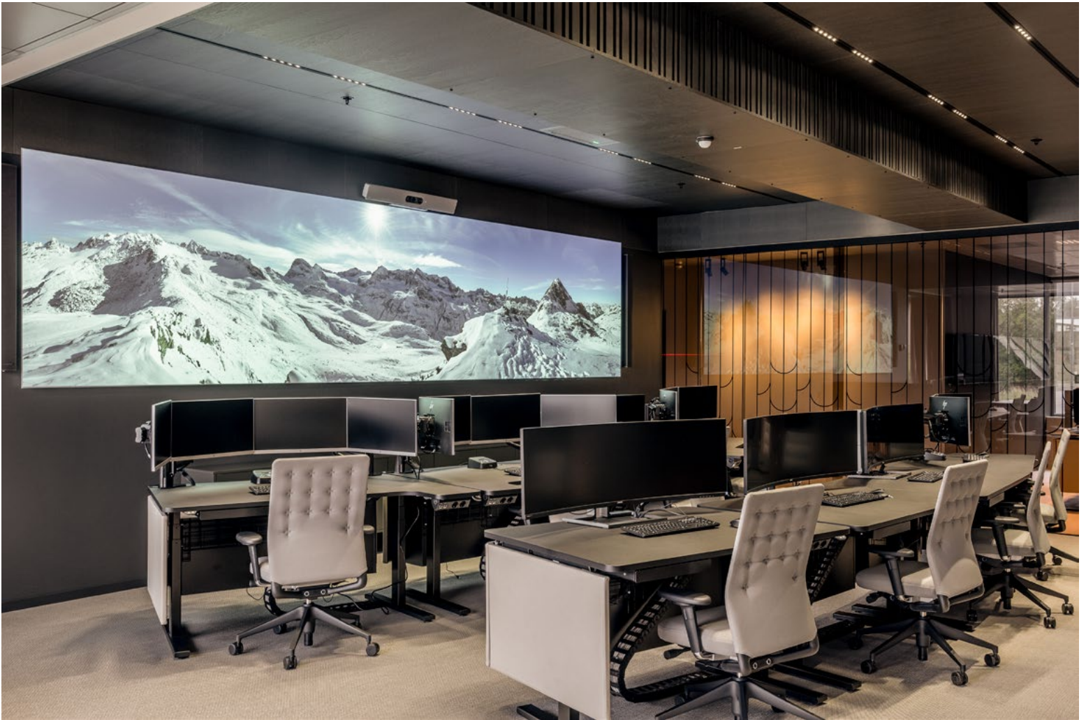
Det er totalt fem rigglinjelerom. Her styres aktiviteten offshore. Store mengder informasjon deles på et åtte meter langt lerret. Det er prosjektet som styrer hvem som sitter her inne, og arbeidsbordene er vendt i bue mot lerret. Rigglinjene har spesialdesignede pulter med skinn i front som skjuler alle tekniske føringer samtidig som det har en akustisk funksjon.
