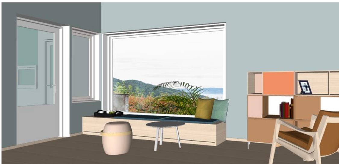
3D-modell brukt som visuelt prosjekteringsverktøy i brukermedvirkningsprosessen og detaljprosjektet. Perspektiv som viser plassbygd sittebenk under vindu mot utsikten. Tegninger → YME arkitekter
