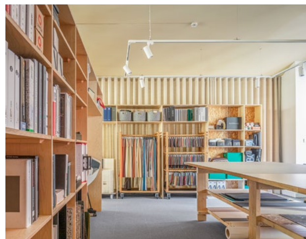
Kontor – Materialrommet er bygget opp av 100% gjenbrukselementer. Alle plater og stenderverk er gjenbrukt fra tidligere kontorer, overskuddsmateriale fra snekker, samt andre byggeprosjekter.
