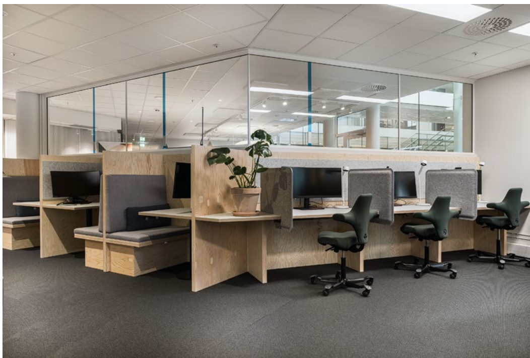
Plassbygde arbeidsplasser langs knevegg mot fellesarealet utenfor. Visuell forbindelse med gjenbrukte kontorfronter på topp av knevegg. Båser for én person langs knevegg.
