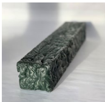
De første plastråvarene var ikke tørre nok og ekspanderte ut av formen under støp, spilene ble derfor støpt på overmål i en form og skåret til format med fres.
