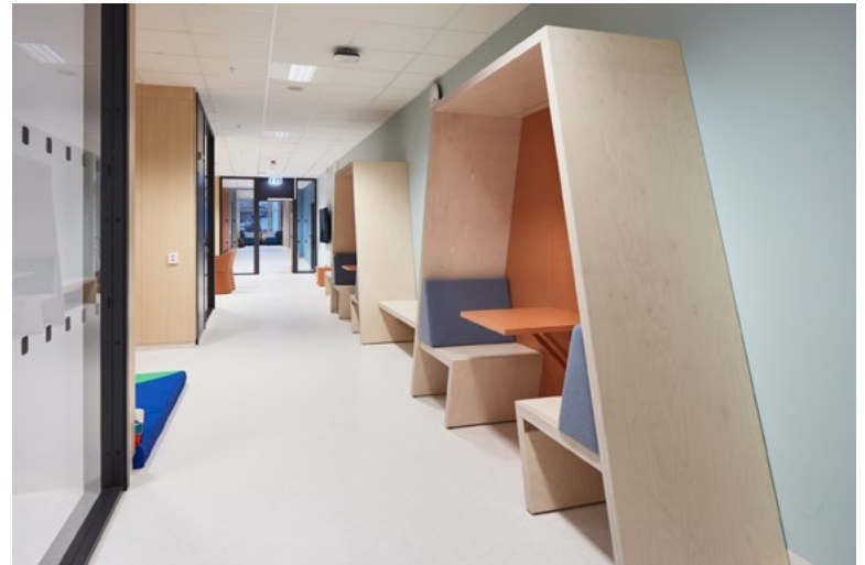
Fastinnredning i underjordisk forbindelse til resten av byggene. Fokus på materialitet og overflater som møter krav til rømning. Plassbygde sitteplasser, som er åpne og mer skjermet, langs den ene vegg. Grupperom med opphold mellom hverandre, skaper åpne og lukkede soner i korridoren for ulike aktiviteter og spill.
